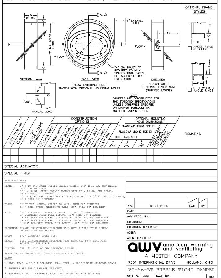
4. LEAKAGE SHALL BE BUBBLE TIGHT PER AMCA 500-D.
